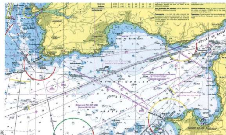
Pointe de Saint-Mathieu et goulet de Brest. Cartes officielles du SHOM : à gauche, la carte raster geotiff, qui sert pour imprimer les cartes papier ; à droite, la carte vectorielle au format S-57. L'une comme l'autre peuvent être téléchargées sur le site du service hydrographique, mais il faut un logiciel compatible, et les prix sont assez élevés.
