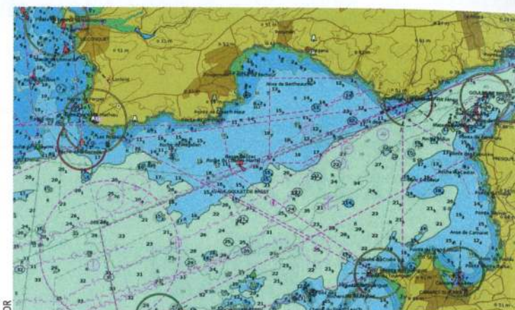
Pointe de Saint-Mathieu et goulet de Brest. Cartes officielles du SHOM : à gauche, la carte raster geotiff, qui sert pour imprimer les cartes papier ; à droite, la carte vectorielle au format S-57. L'une comme l'autre peuvent être téléchargées sur le site du service hydrographique, mais il faut un logiciel compatible, et les prix sont assez élevés.
