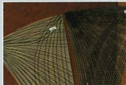
L'idée est de laminier un tissu spécifique pour chaque voile, c'est pourquoi l'on parle de laminés à fibres orientables ou membrane. Leur fabrication demande moins de fils permettant ainsi un gain de poids non négligeable, une meilleure stabilité de forme tandis que le vieillissement de la voile reste homogène. Côté négatif, cette technologie est onéreuse car pour chaque voile, la membrane est une nouvelle conception. Elle reste rare en croisière...
