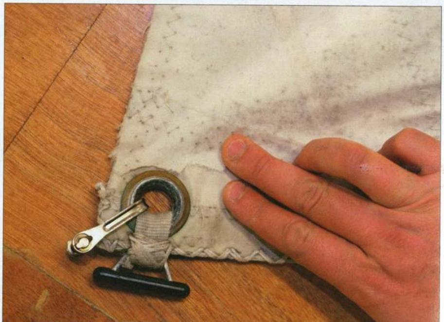
▲ Une usure prononcée autour du point d'écoute doit vous alerter : la voile est à changer !
