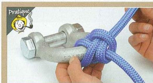
▲ Le nœud de cabestan a tendance à glisser. Pour le sécuriser, faites une demi-clé autour du dormant. Le courant de la demi-clé doit être parallèle à la boucle qui verrouille le nœud de cabestan.
