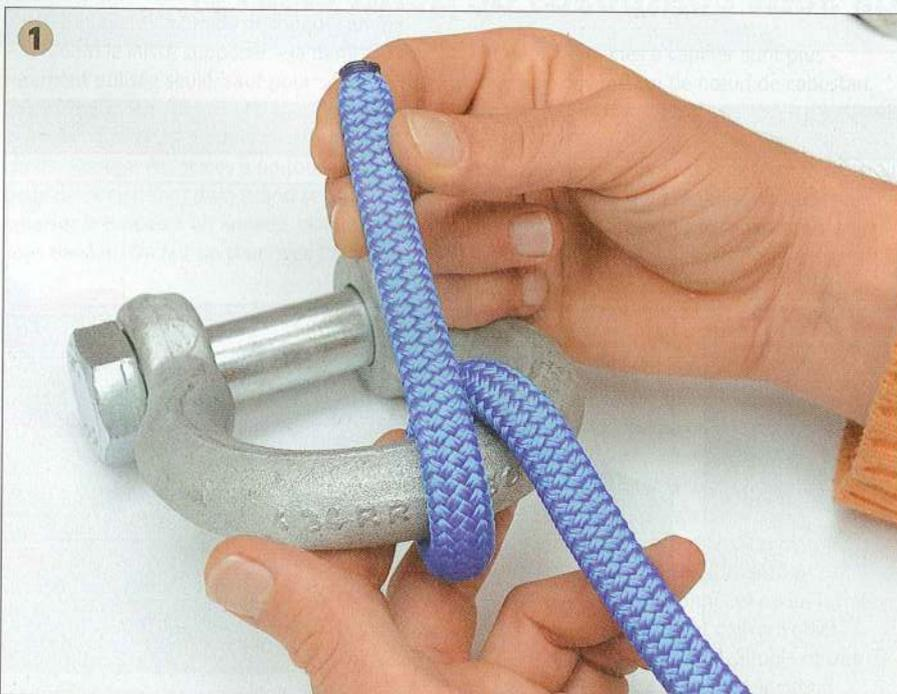
1 ▲ Une des manières de réaliser le nœud de cabestan est d'utiliser l'extrémité du bout, par exemple pour nouer le cordage d'un pare-battage sur une filière (ici représentée par une grosse manille).
