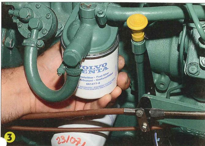
▲ Le filtre doit être vissé à la main. Quand le joint est en contact avec le support du filtre, serrez d'un demi-tour supplémentaire (ne serrez pas trop le filtre pour que le montage soit étanche!).
