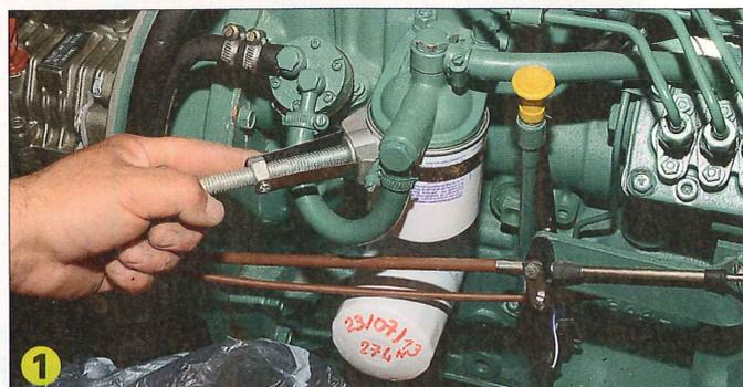
▲ Le filtre à gasoil est placé en aval de la pompe d'alimentation (forme ronde à gauche du porte-filtre). Dévissez-le à l'aide d'une clé à filtre.
