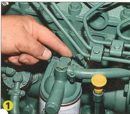
1 Pour purger le circuit de gasoil, dévissez la vis de purge située sur le filtre. Lorsqu'il n'y a plus de bulles qui s'échappent, revissez. Si besoin, dévissez les raccords des tuyaux des injecteurs (cf. schéma). Il est plus facile de purger un moteur chaud.
