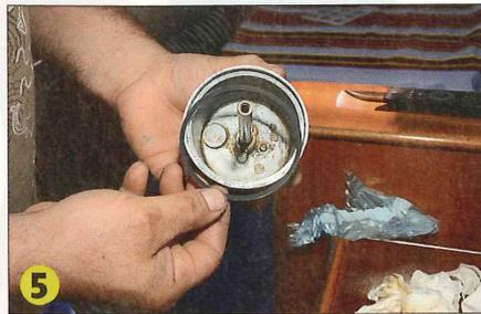
▲ Remontez le préfiltre avec une cartouche neuve (modèle indiqué dans la notice du moteur), après avoir remplacé le joint d'étanchéité.
