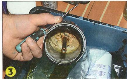
▲ Démontez le préfiltre (entre le réservoir et la pompe d'alimentation) en dévissant la vis centrale. Retirez la cartouche et jetez-la.
