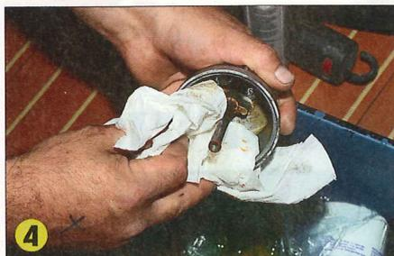
▲ Retirez toutes les impuretés en nettoyant la cuve et la portée du joint (vous pouvez utiliser du gasoil), puis séchez l'ensemble avec un chiffon propre.
