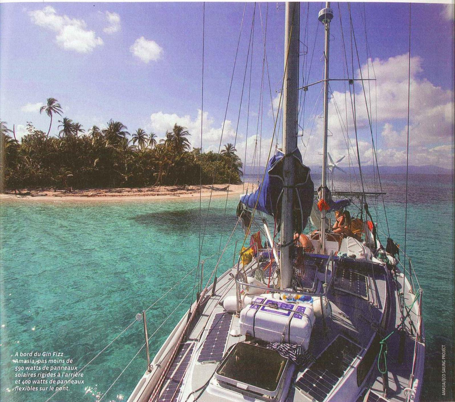
A bord du Gin Fizz, Amasia, pas moins de 590 watts de panneaux solaires rigides à l'arrière et 400 watts de panneaux flexibles sur le pont.
