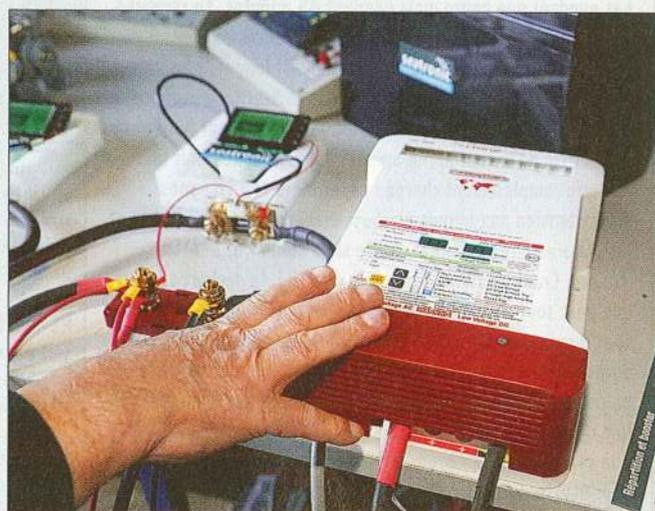
▲ Il est indispensable d'acquiescer un chargeur 220 V compatible avec la capacité de recharge de vos batteries : la tension acceptable.
