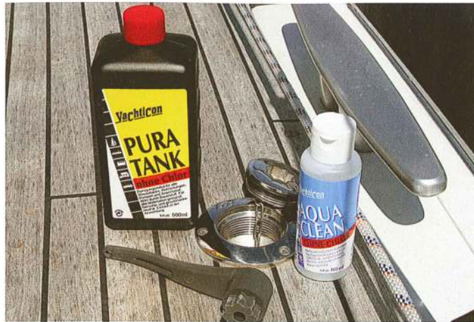
Im Frühjahr sollte der Tank regelmäßig gereinigt werden. Während der Saison kann das Wasser konserviert werden
