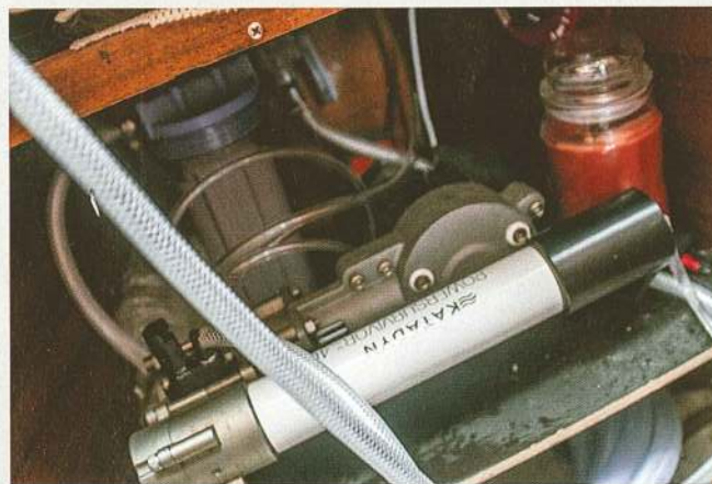
Ein kleiner Watermaker für den Notfall findet überall an Bord Platz. Fünf Liter produziert dieser Katadyn pro Stunde
