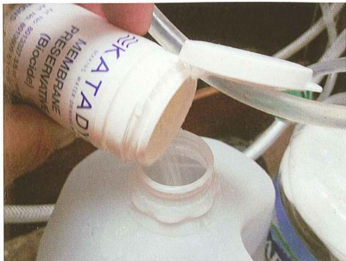
,to pickel, – einlegen, nennt man das Konservieren eines Watermakers mit speziellem Biozid für Watermaker auf Englisch
