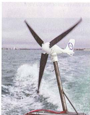
Nos éoliennes (ici l'ATMB 350) étaient montées sur un mât incliné afin de simuler la gîte.
