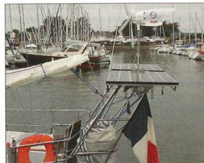
▲ Le portique a permis d'accueillir deux panneaux rigides de bonne puissance (590 W).
