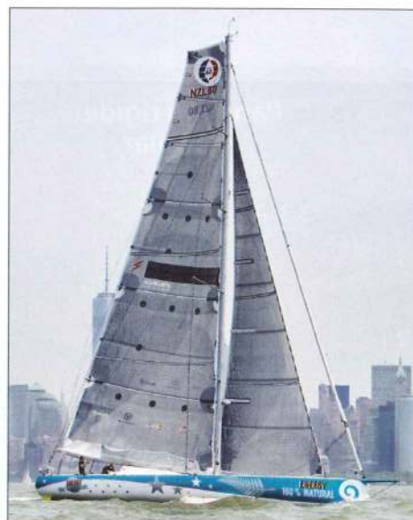
▲ Le 60 pieds de Conrad Colman est équipé d'une GV à cellules photovoltaïques UK Sailmakers.
