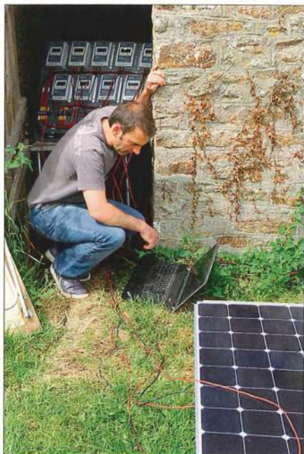
▲ Les mesures en sortie des régulateurs MPPT sont directement traitées sur ordinateur.
