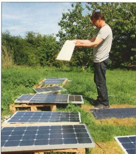
▲ Une partie des tests effectués aura pour but de déterminer l'influence d'une ombre portée.
