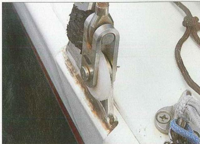
▲ A bord de Flash, l'écoute de spi venait tout le temps se coincer dans la chappe du ridoir de galhauban. Pour remédier à ce souci, Eric et Walden ont inséré une rondelle en Téflon pour combler l'espace.
