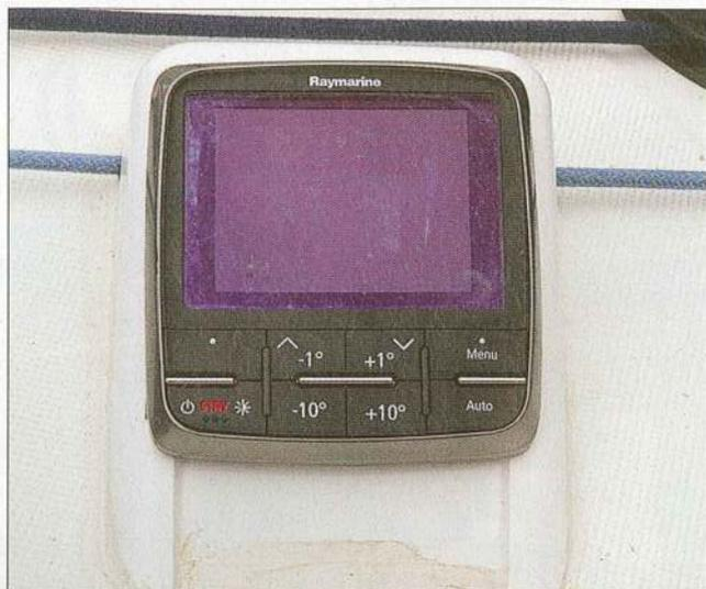
▲ Pour monter ce pupitre de pilote juste devant le poste de barre et permettre le passage du barber, le support collé époxy n'est autre qu'une barquette plastique renversée et coupée à la bonne taille.
