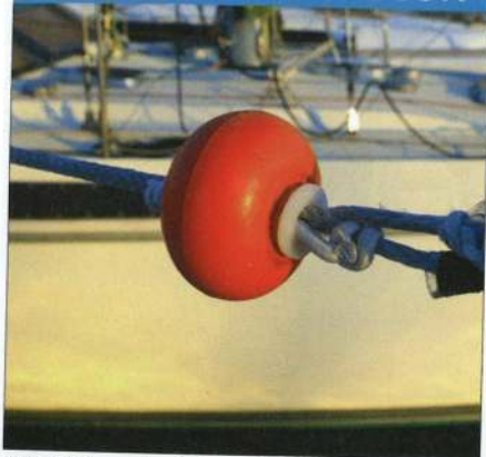
▲ Un flotteur de pêche sur les filières permet de faire passer le génou en douceur.
