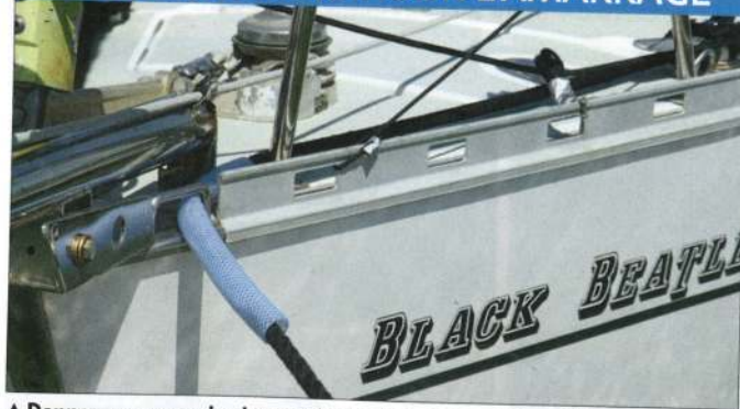
▲ Donnez une seconde vie aux vieux tuyaux en protégeant les amarres du ragage.
