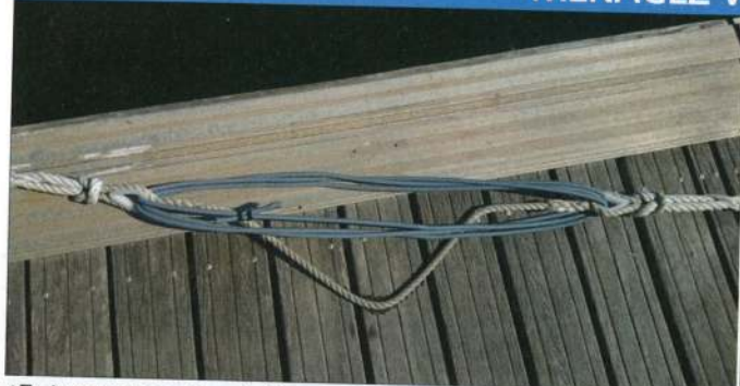
▲ Trois tours de sandow de 10 mm, soit six brins pour amortir les amarres. A gauche, les cosses sont bloquées par des épissures, à droite elles sont incluses dans le cordage et bloquées par des colliers inox. Il est possible de faire varier l'amortissement en variant le diamètre du sandow.
