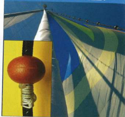
▲ Sur un câble anti-torsion, ce lecteur a placé des flotteurs pour un emmagasineur économique.
