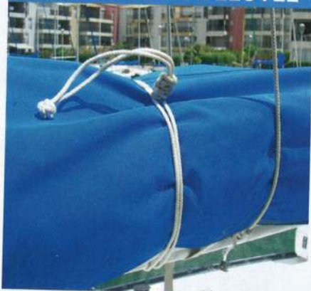
▲ Une garcette doublée et une navette tressée pour maintenir une voile ferlée, avec classe.
