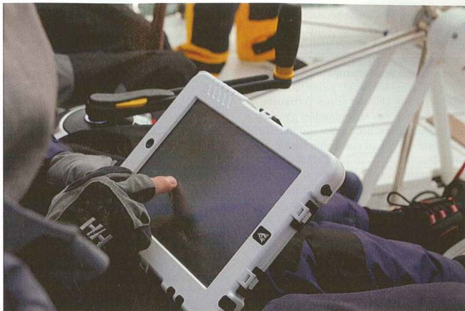
Zur Navigation kann ein Tablet mit Navigationssoftware verwendet werden. Es sollte allerdings eine Redundanz in Form von GPS und Papierkarten vorhanden sein
