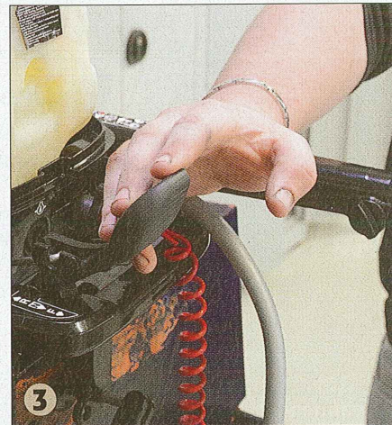
3 ▲ Quand le réglage de la vis de richesse est convenable, n'y touchez plus et peaufinez le réglage du ralenti (vis avec le ressort), moteur embrayé, afin qu'il ne cale pas.
