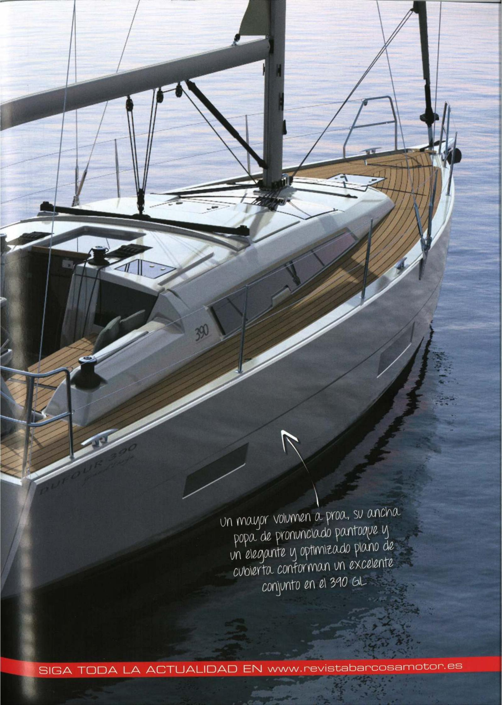
Un mayor volumen a proa, su ancha popa de pronunciado pantoque y un elegante y optimizado plano de cubierta conforman un excelente conjunto en el 390 GL
