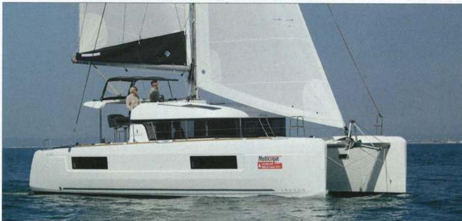
**Long. hors tout : 11,73 m. Largeur : 6,76 m. TE : 1,35 m. Déplacement : 10 880 kg. SV au près : 81 m<sup>2</sup>. Architectes : VPLP. Matériau : sandwich verre/balsa. Constructeur : CNB Lagoon. Prix : 307 200 €.**
