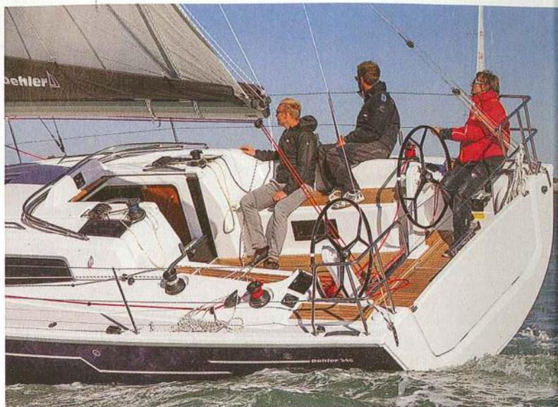
**Efficace.** L'écoute de grand-voile tire bien sur l'arrière de la bôme, et on la contrôle facilement avec le montage dit «à l'allemande».
