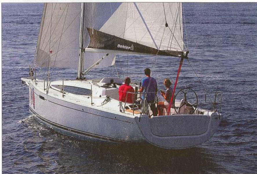
▲ Plateforme de bain relevée, le cockpit est bien protégé, défendu sur les côtés par des hiloires bien proportionnées qui suivent une courbe douce jusqu'au passavant.
